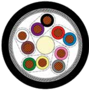
Aufdruck-Beispiel für L0390-9696: SAB BRÖCKSKES · D-VIERSEN · Special Cable 5x2x0,50mm 2 0390-9696 €€ (SAB Ident. Nr.)
